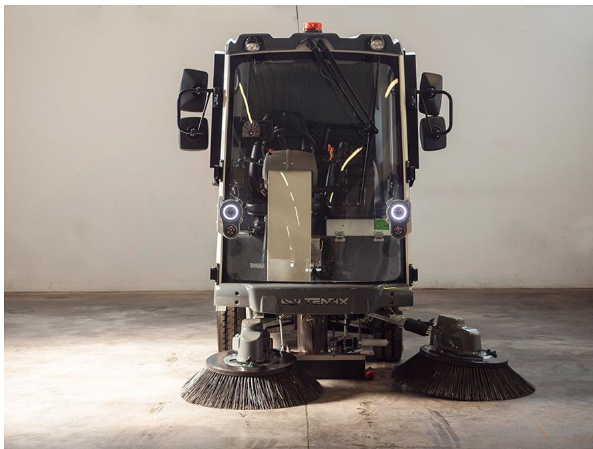
Függetlenül pozícionálható kefék
