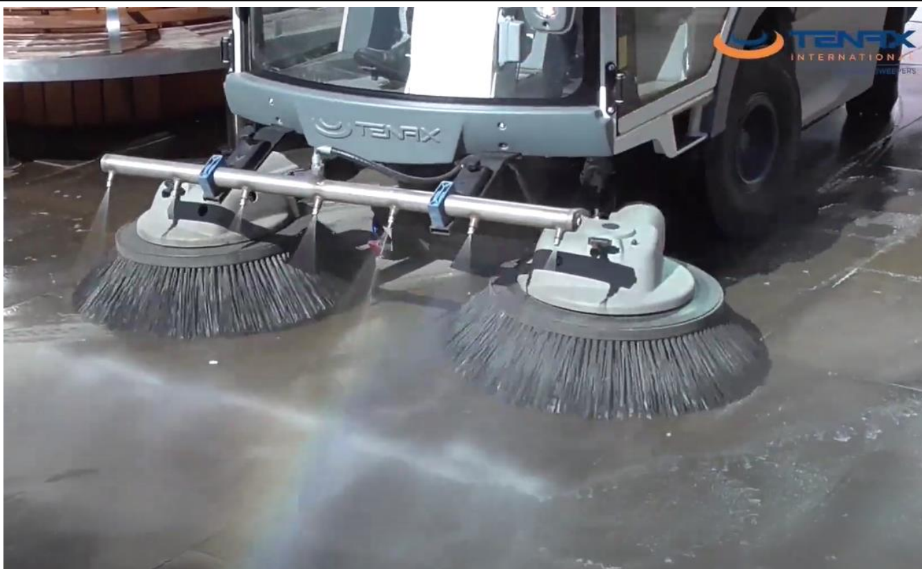
Nagynyomású felületmosó - gerendely (opció). A víz kapacitás egy opcionális vízvisszaforgató rendszer segítségével kb. 600l-re bővíthető.
