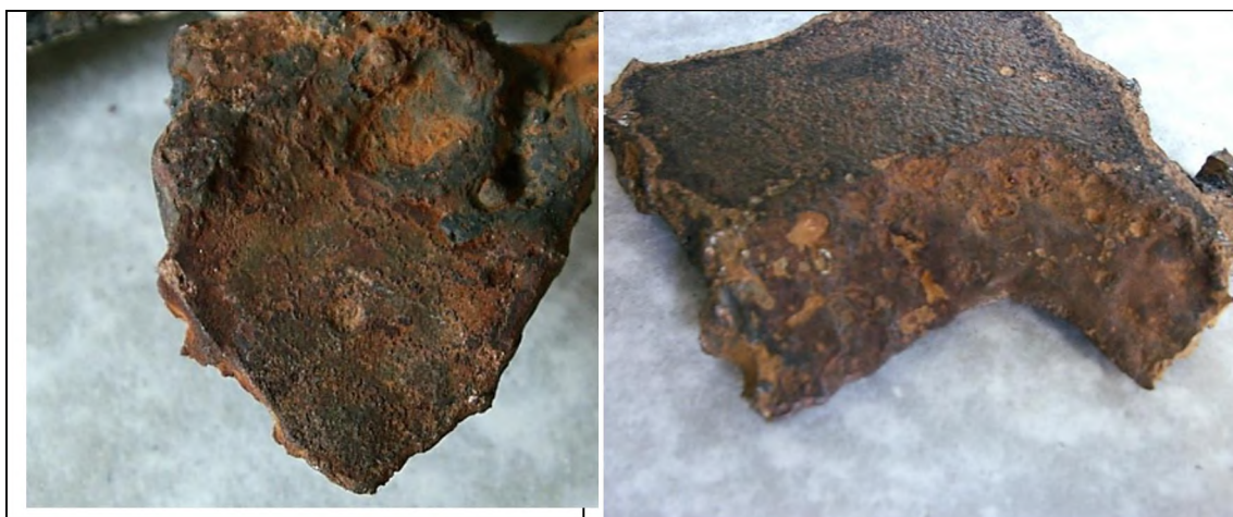
Gubacsi medercső darabok a sérülésnél
